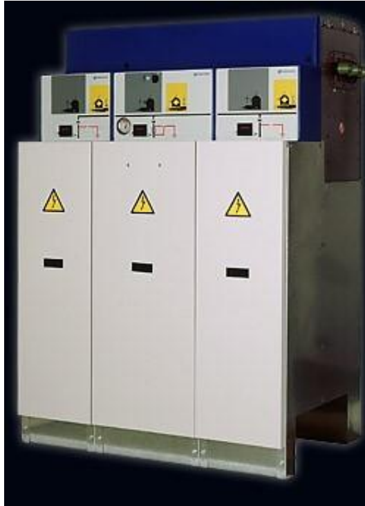
Figura 6. Conjunto de celdas modulares con aislamiento integral en SF6, 24 kV, 630 a, 20 kA.
