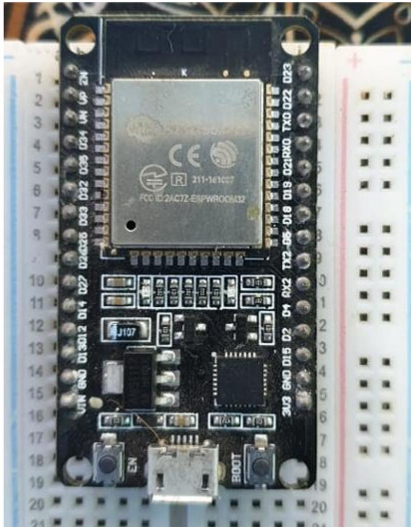
**Figura 2. Imagen real Módulo ESP-WROOM 32**
