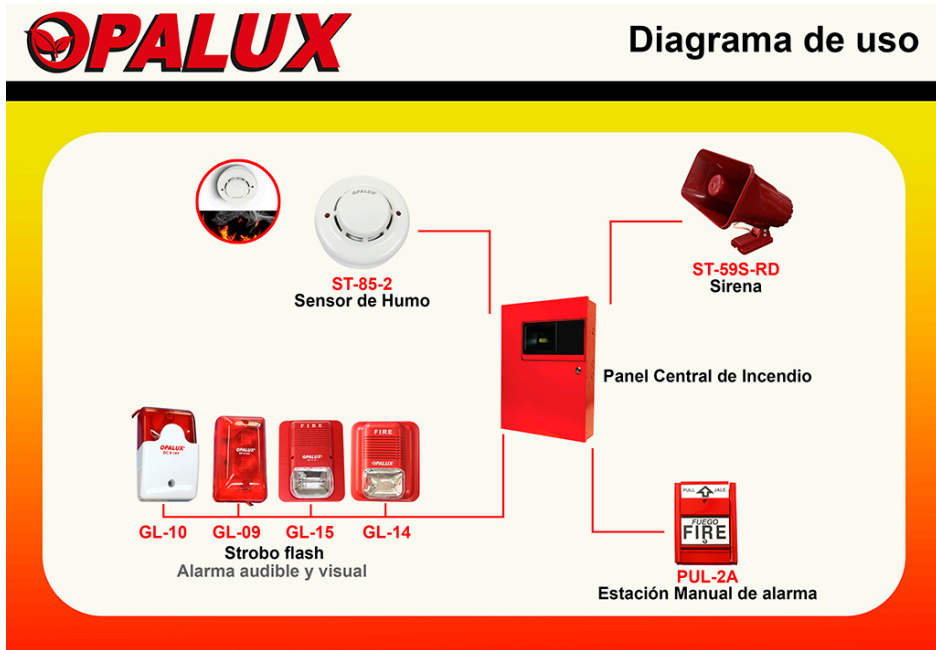
Figura 1.12. Sistema de alarma contra incendio
