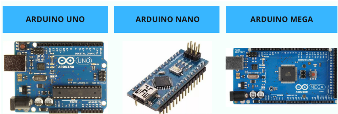
Figura 1.1. Ejemplos de tarjetas de desarrollo Arduino Fuente: Elaboración propia - Google imágenes
