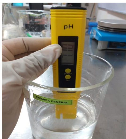
Figura 27. Medición del pH de la muestra antes de realizar el tratamiento
