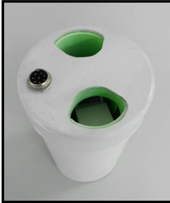
Figura 48. Vista inferior del equipo de medición de precipitación
