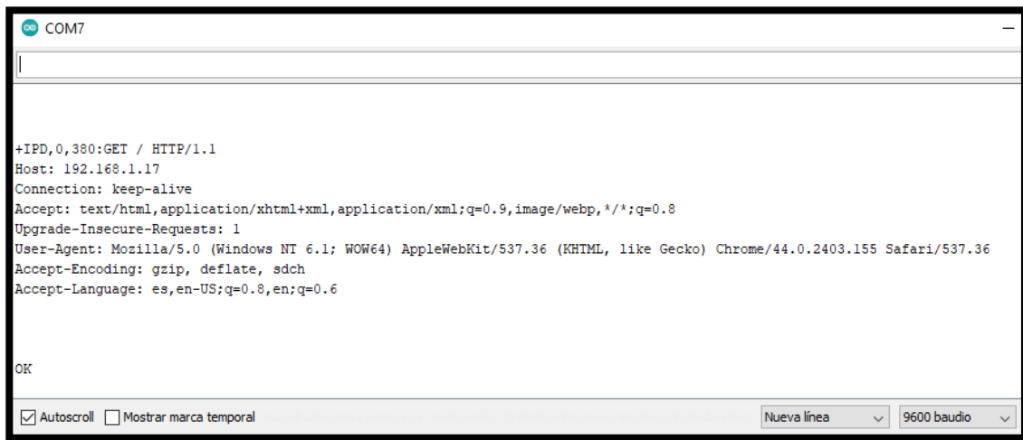
Figura 36. Respuesta del AP con la IP del ESP8266 Fuente: Elaboración propia
