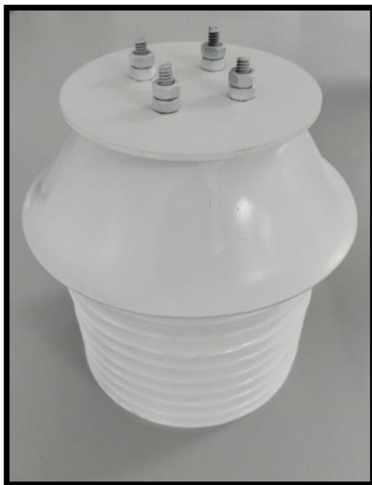
Figura 41. Equipo de temperatura y humedad ensamblado Fuente: Elaboración propia
