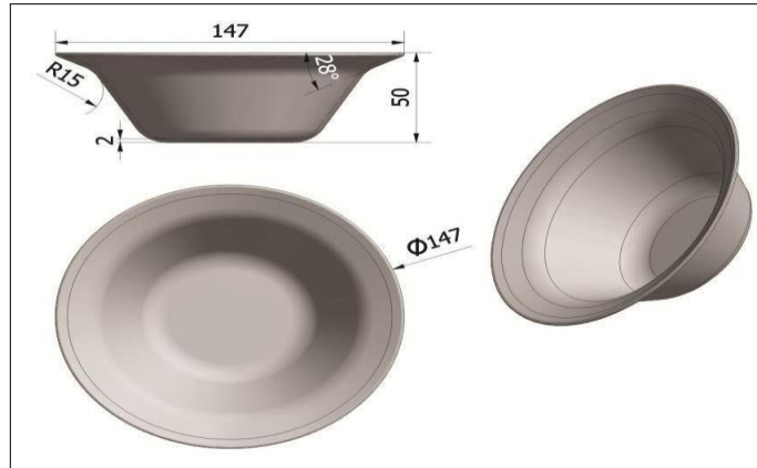
Figura 14. Dimensiones en mm de la campana base
