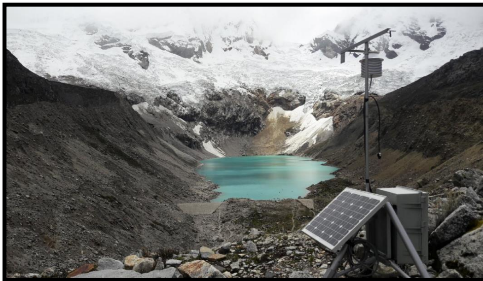
Figura 52. Implementación del equipo de temperatura humedad y precipitación en Palcacocha. Fuente: Elaboración propia
