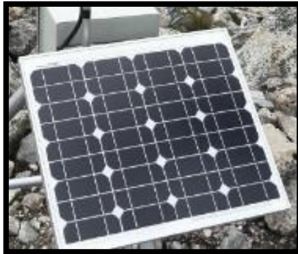
Figura 30. Panel solar 10W, 12V Fuente: Elaboración propia
