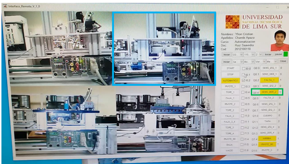
Figura 65. Detección del sensor derecho de la Estación de Montaje Fuente: Elaboración Propia
