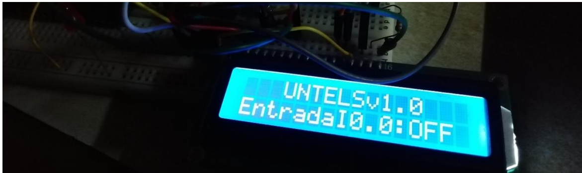
Figura 41. Visualización del apagado del puerto del PLC, recibido por el puerto serial Fuente: Elaboración Propia
