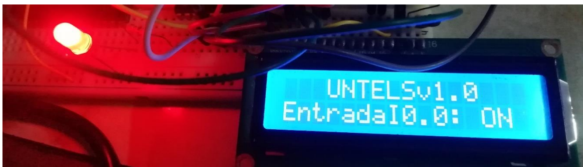
Figura 40. Visualización del encendido del puerto del PLC, recibido por el puerto serial Fuente: Elaboración Propia
