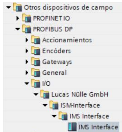
Figura 45. Reconocimiento de los Módulos Lucas Nülle GmbH Fuente: Elaboración propia utilizando el software TIA Portal
