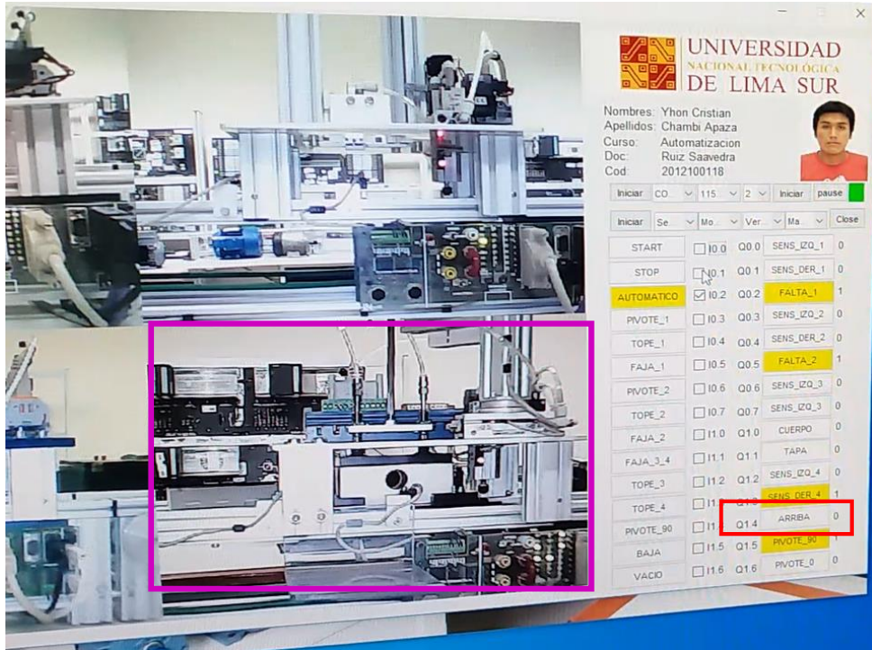
Figura 69. El pivote desciende Estación de Manipulación Fuente: Elaboración Propia
