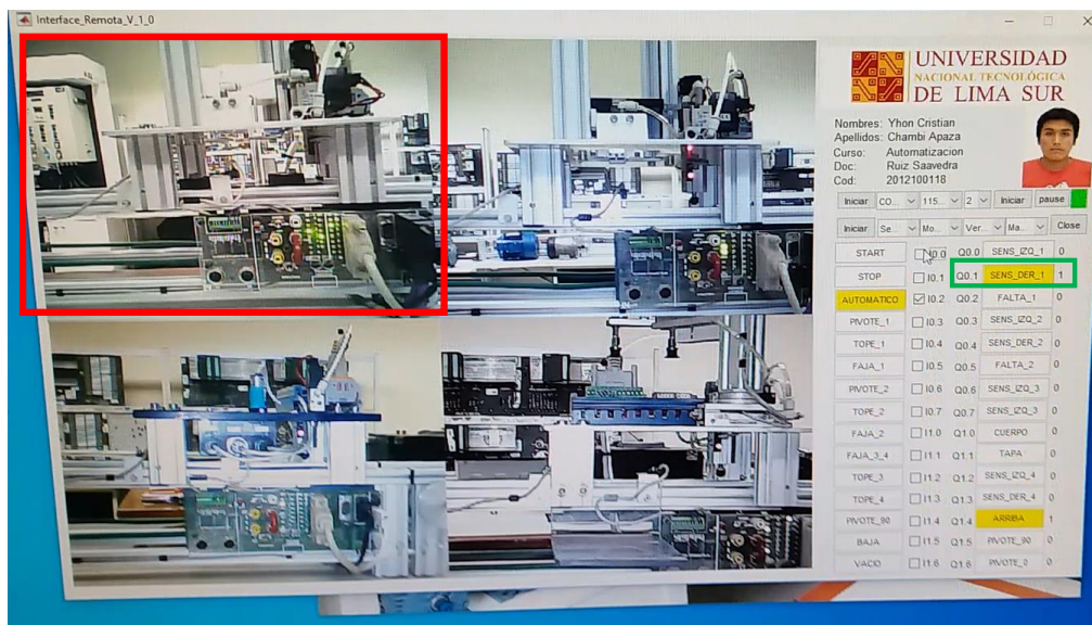
Figura 63. Detección del sensor derecho de la Estación de Separación Fuente: Elaboración Propia
