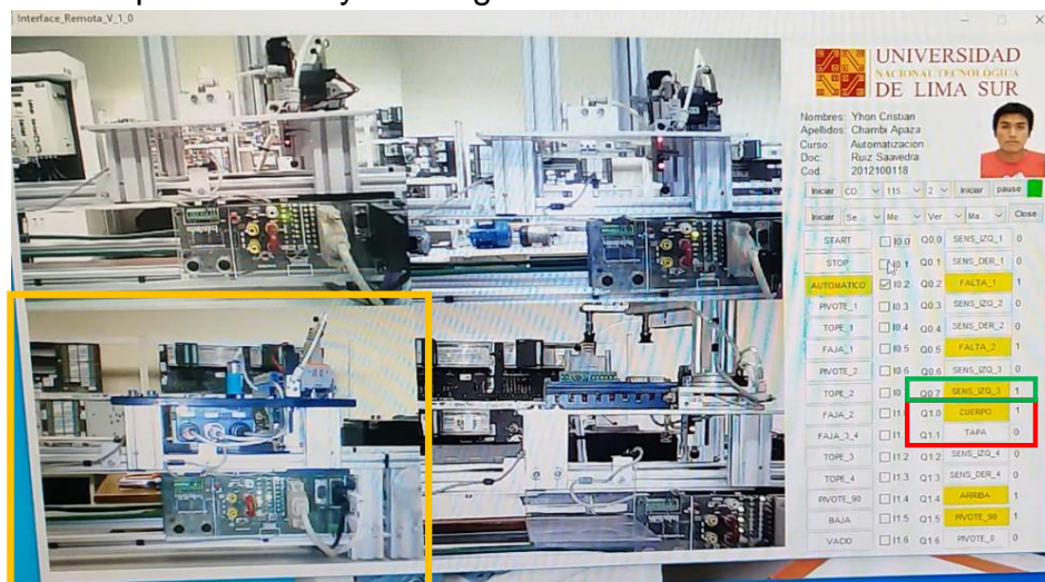
Figura 67. Detección del sensor derecho de la Estación de Verificación Fuente: Elaboración Propia
