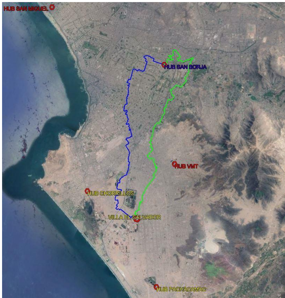
Figura N° 22: Enlace principal y redundante para la filial Villa el Salvador Fuente: Elaboración propia
