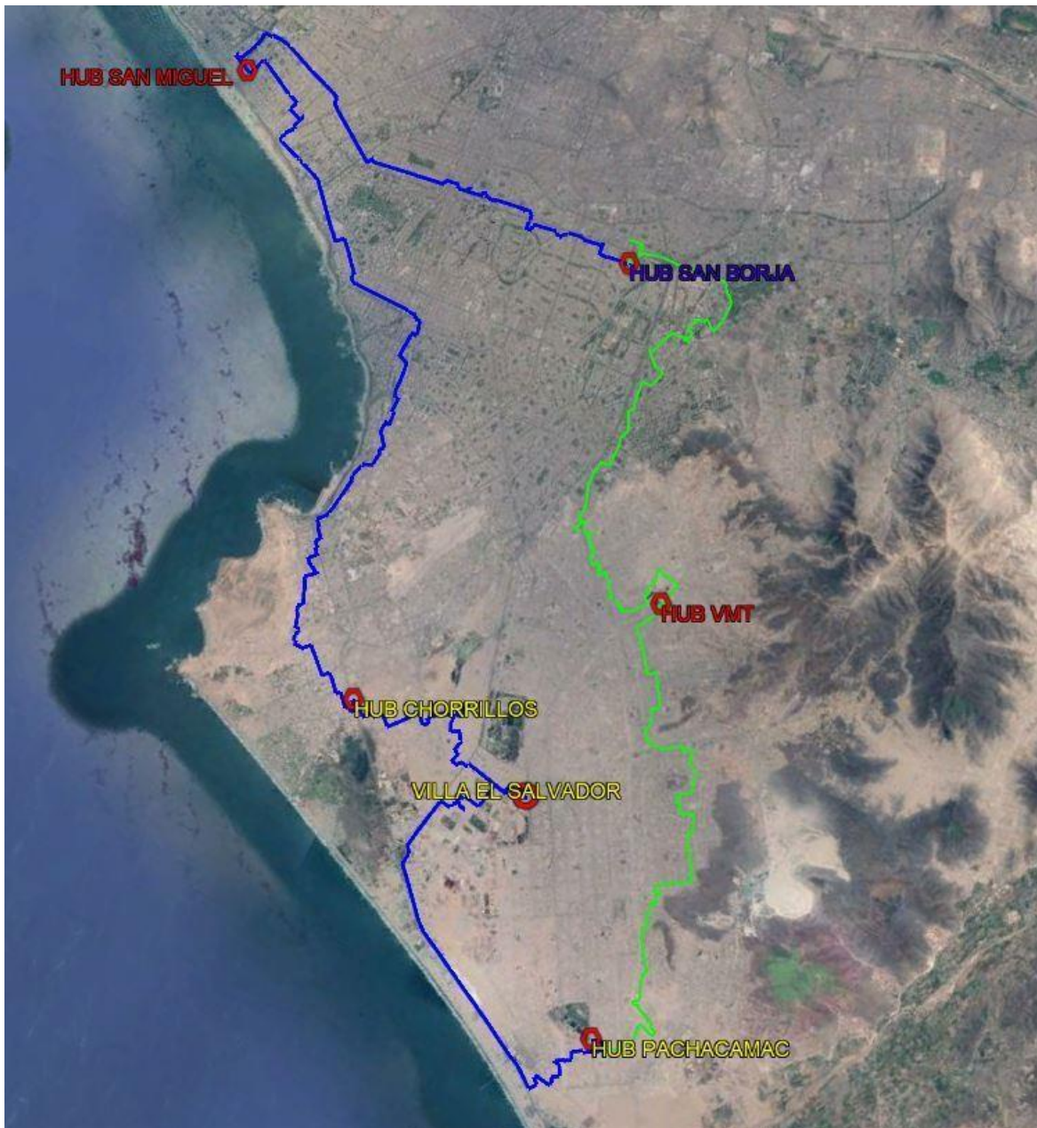
Figura N° 26: Enlace principal y redundante para la filial de Pachacamac Fuente: Elaboración propia
