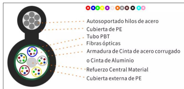
Figura 7. Estructura interna un cable tipo Figura 8
