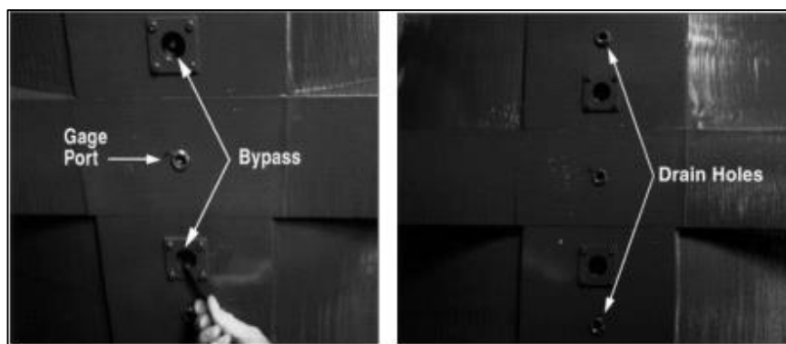
Figura 15: Puertos de bypass interno y drenaje Fuente: Manual de la válvula de sándwich marca TD WILLIAMSON.
