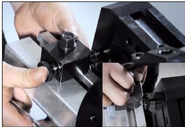
Figura 28: Ubicación de Pin de Contacto con Engranaje de Accionamiento Fuente: Manual del equipo de corte en frío TRI TOOL.
