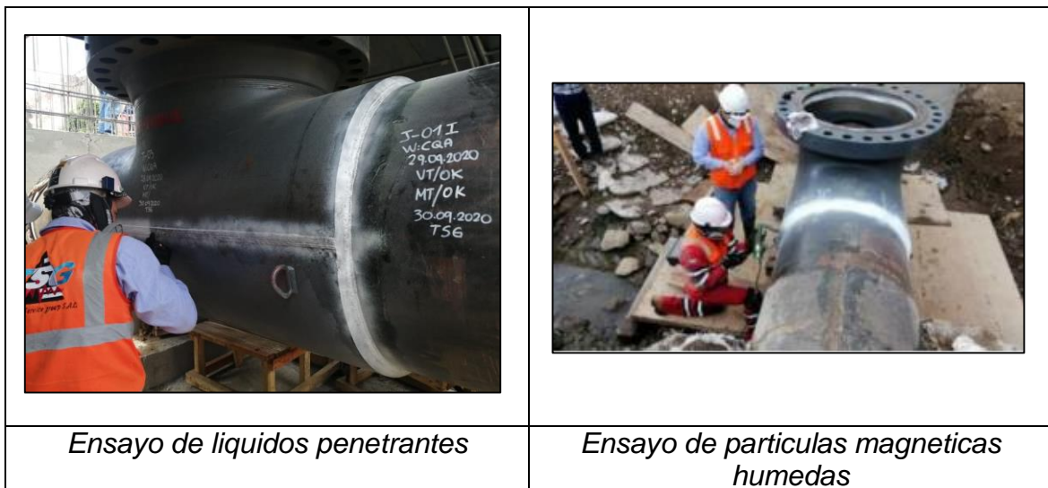
Figura 46: Aplicación de END a los Split tee Fuente: Elaboración propia
