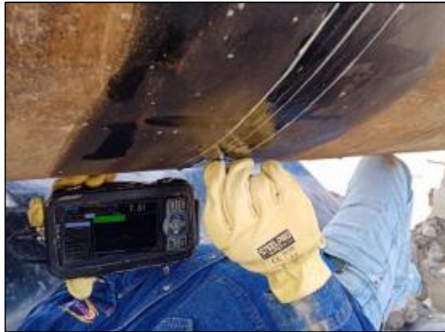
Figura 39: Posición inclinada de la toma de medidas de espesor Fuente: Elaboración Propia
