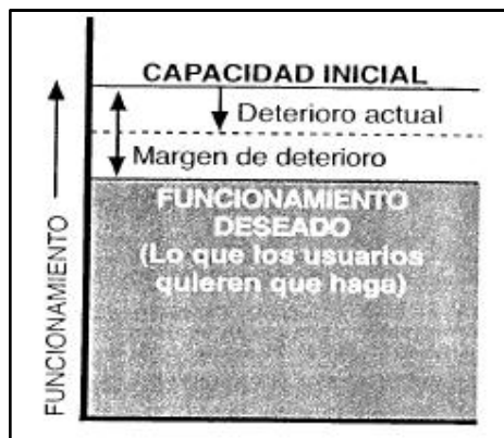
Figura 4. Funcionamiento activo a pesar de su deterioro
