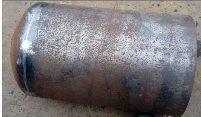
Figura 27. C) Inspección de acabado final aplicando el proceso GMAW-RMD. Fuente: Propia
