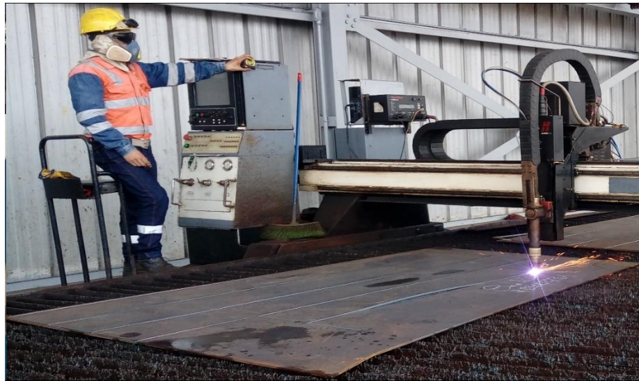
Figura 20. Corte por plasma-zona habilitado
