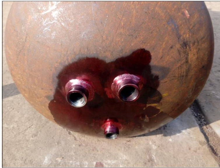
Figura 28. A) Aplicación de tintes penetrantes en las conexiones de 3/4 y 1/2 de diámetro
