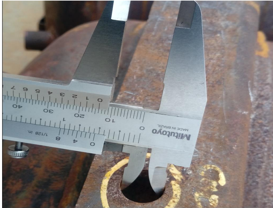
Figura 24. C) Medición de agujero a agujero respecto a los soportes.
