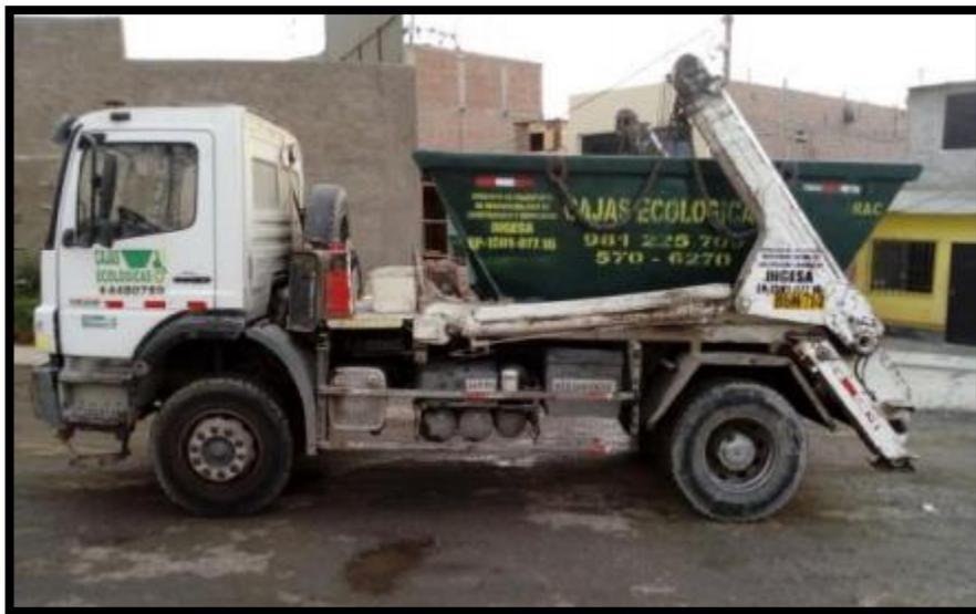
*Figura 18.* Unidad vehicular con su respectivo contenedor metálico para el recojo y transporte de RCD (Cajas Ecológicas S.A.C., 2019)
