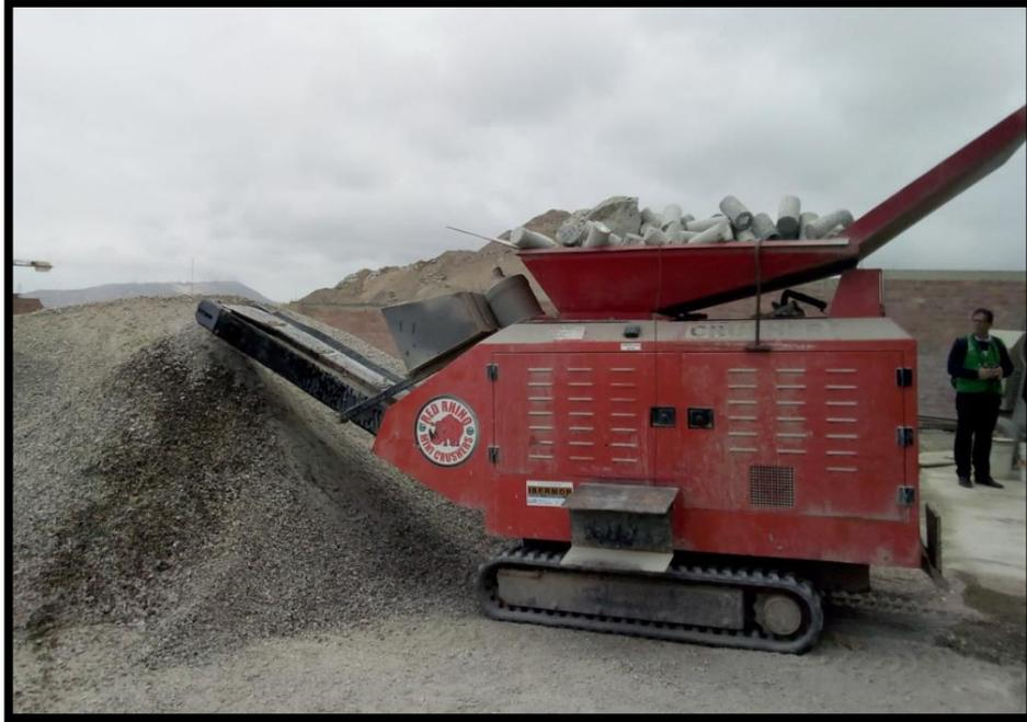
Figura 21. Máquina trituradora para agregados reciclados (Propia, 2019)
