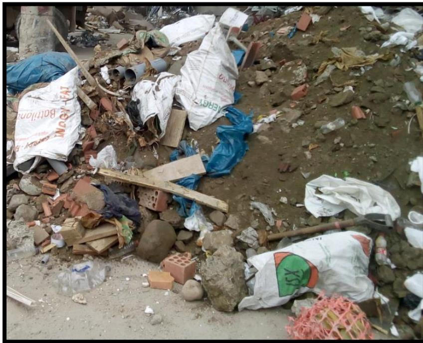
*Figura 25.* RCD provenientes de obras de construcción recolectados en la planta de transferencia y reciclaje de Cajas Ecológicas S.A.C. (Propia, 2020)
