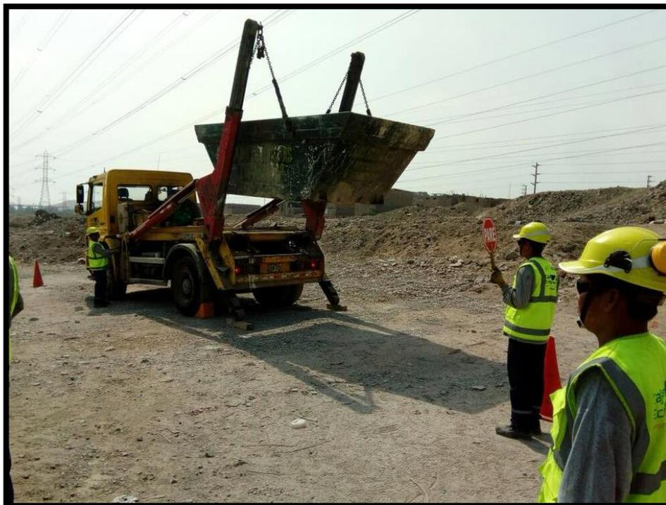
*Figura 19.* Levantamiento de contenedor para su colocación en el suelo (Cajas Ecológicas S.A.C., 2018)
