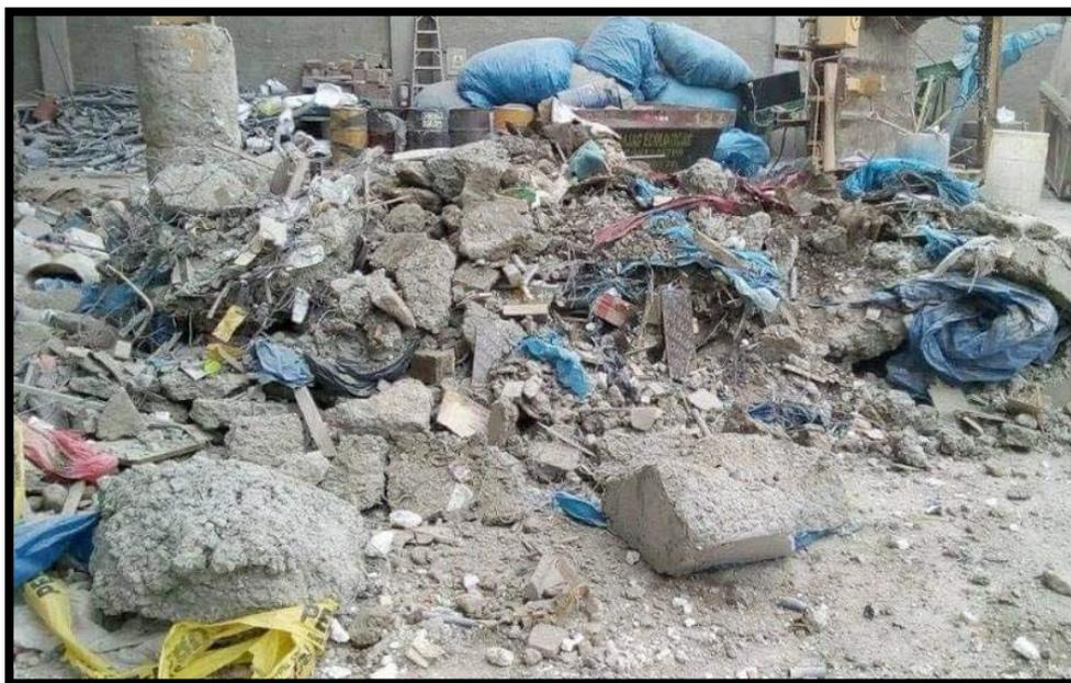
*Figura 23. RCD basculados en el área central de acopio de la planta de transferencia y reciclaje para la segregación (Propia, 2020)*
