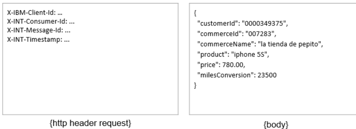
Figura 31. Estructura PUT (Elaborado por la investigadora).
