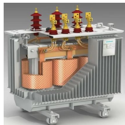
Fig. 1. Disposición general del transformador de potencia.
