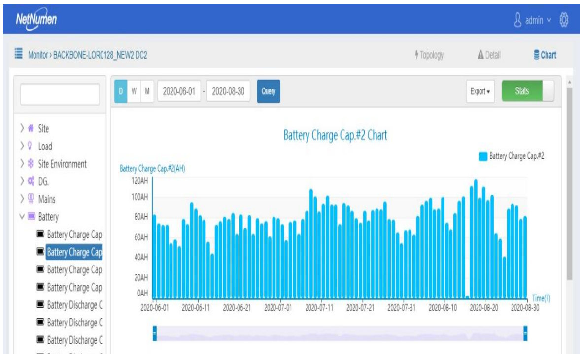
Figura 24. Capacidad de carga del segundo banco de baterías en el DC System 2. Fuente: Propia.
