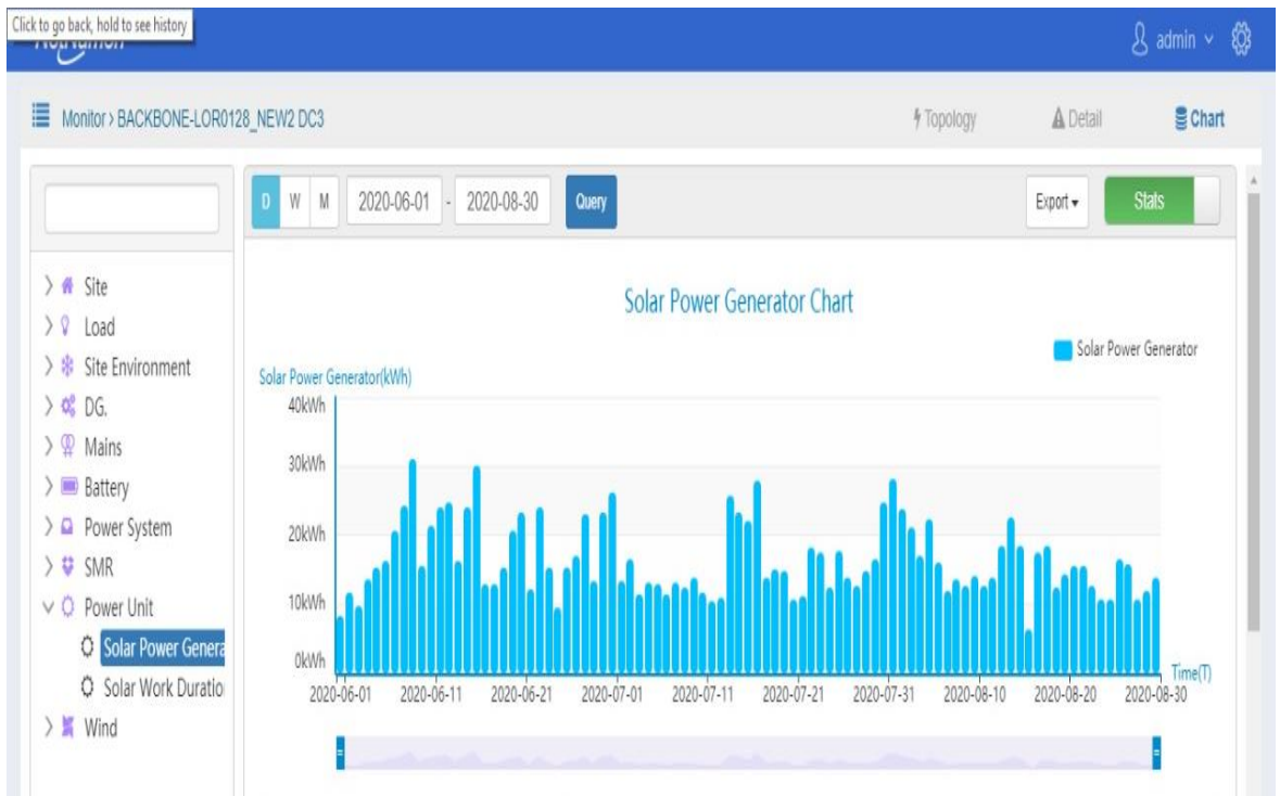
Figura 26. Generación de energía Solar del DC System 3. Fuente: Propia.
