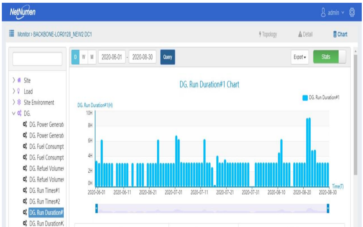
Figura 17. Duración del encendido del primer generador en el DC System1 Fuente: Propia.
