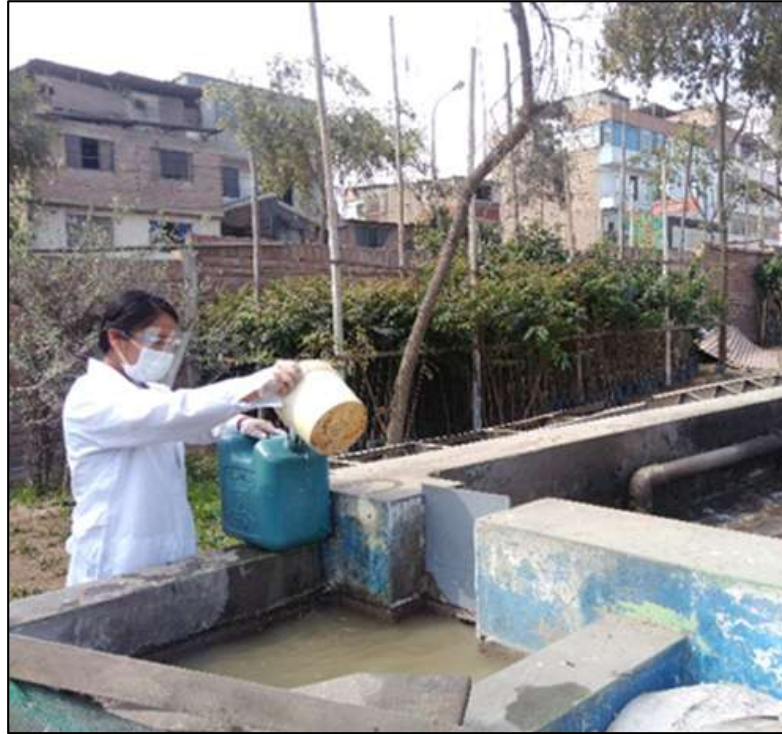
Figura 17. Toma de muestra del agua residual de la zona del afluente
