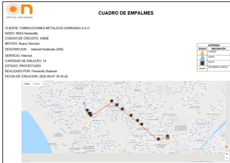
Figura 9. Cuadro de empalmes utilizando el software opticore
