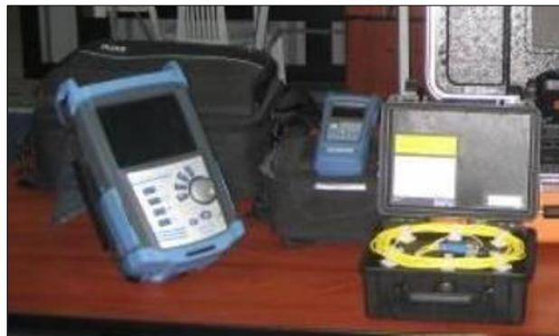
Figura 2. APARATO OTDR Y SUS COMPONENTES
