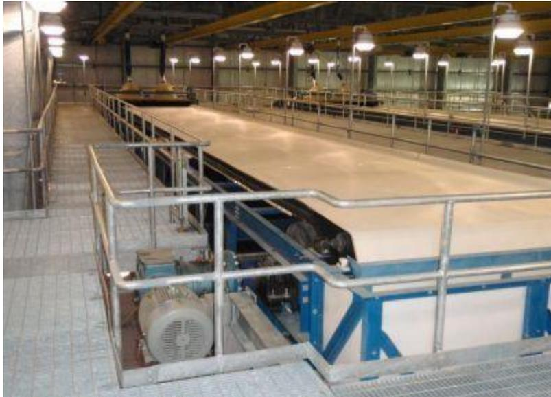
**Figura 6:** Filtro mono banda de succión al vacío.
