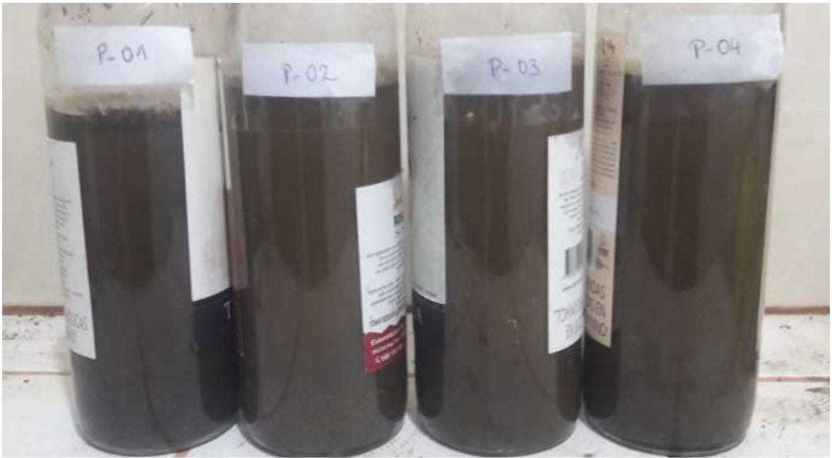
Método de sedimentación con las muestras obtenidas en campo
