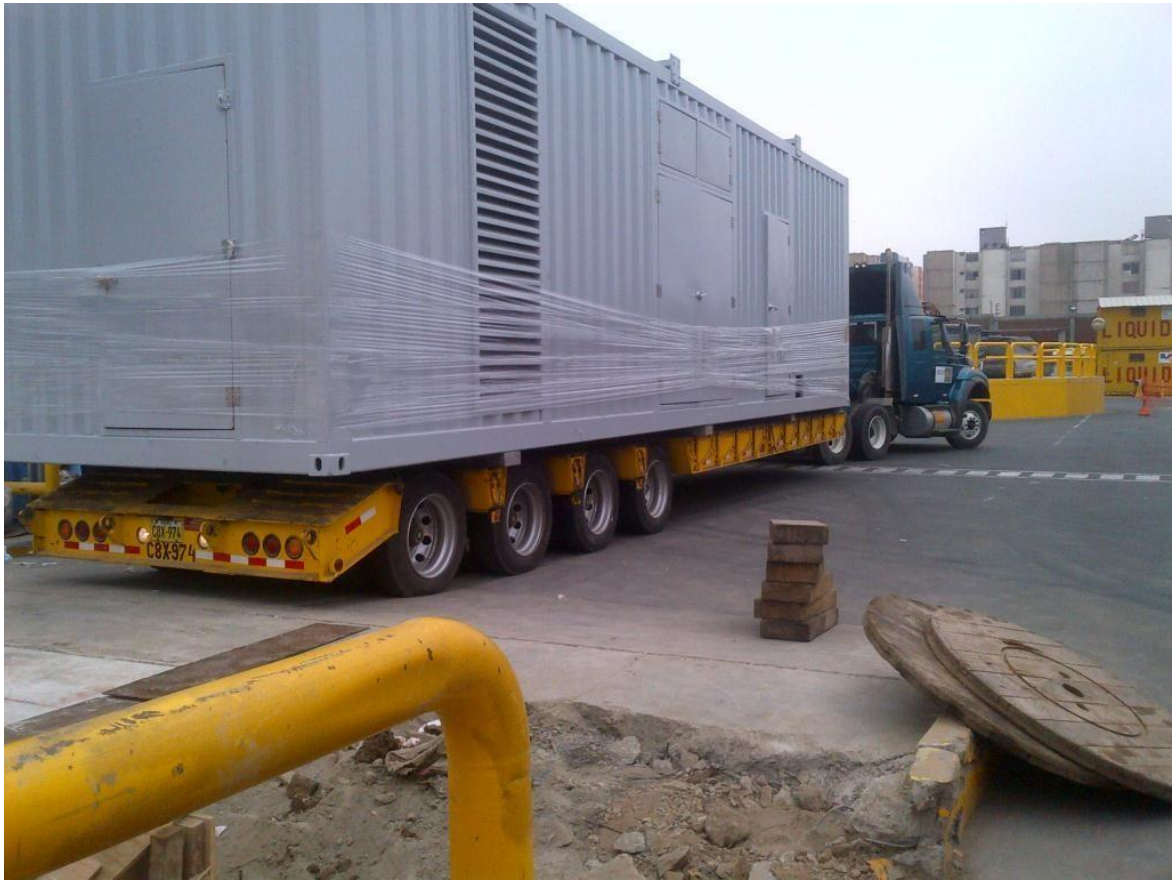
Figura N° 36 - Traslado de generador
