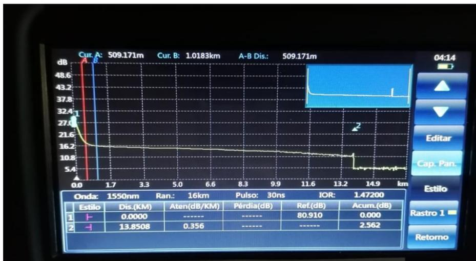
**Figura 52.** Medición de fibra multimodo
