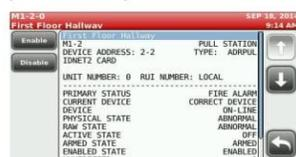
La **pantalla de alarma del sistema** identifica las alarmas activas con identificadores personalizados, y las teclas de dirección permite explorar la lista.
