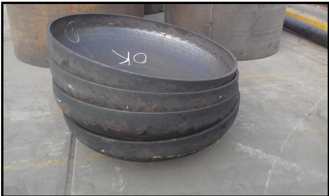
Imagen A.7.6. Cabezas elipsoidales, después de ser revisadas por MT.
