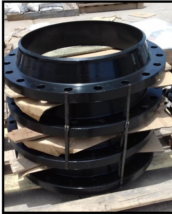
Imagen A.7.1. Recepción de bridas Welding Neck de 24”.
