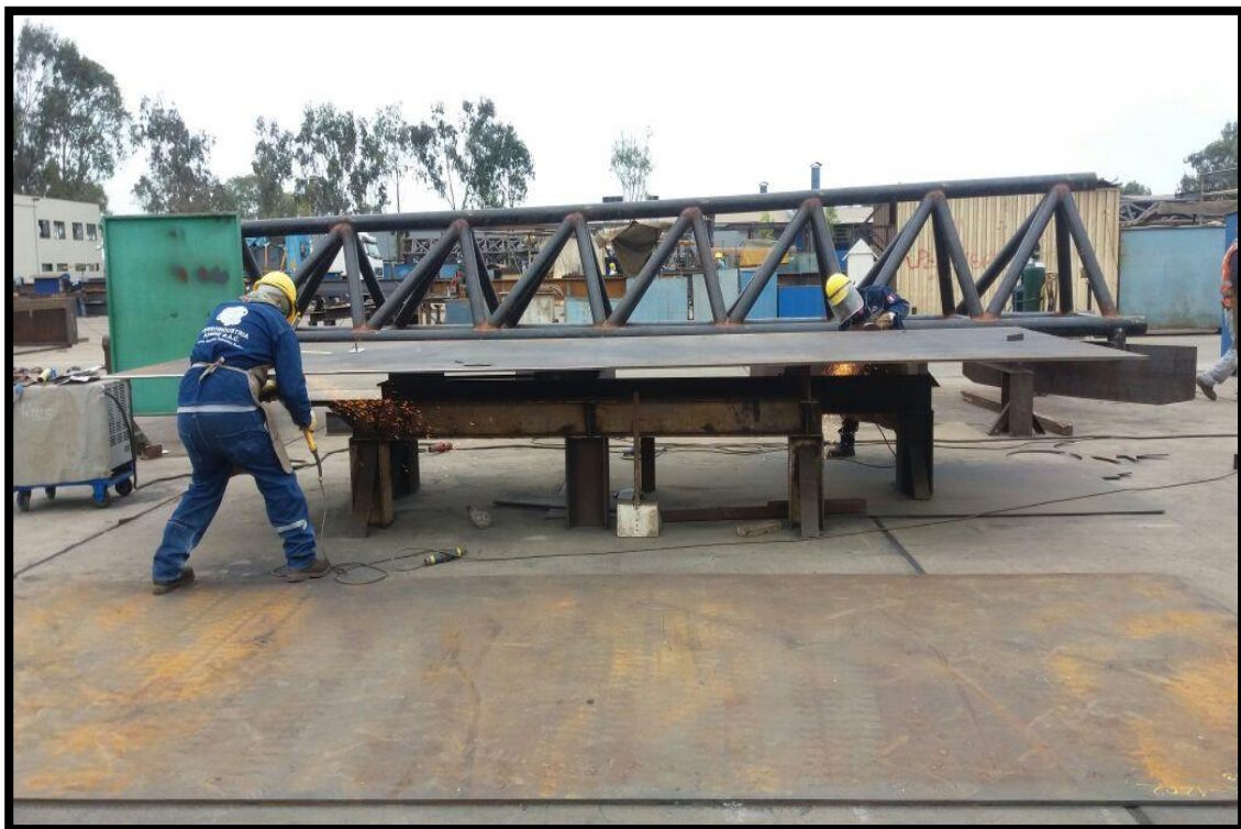
Imagen A.7.2. Biselado de Planchas del casco.
