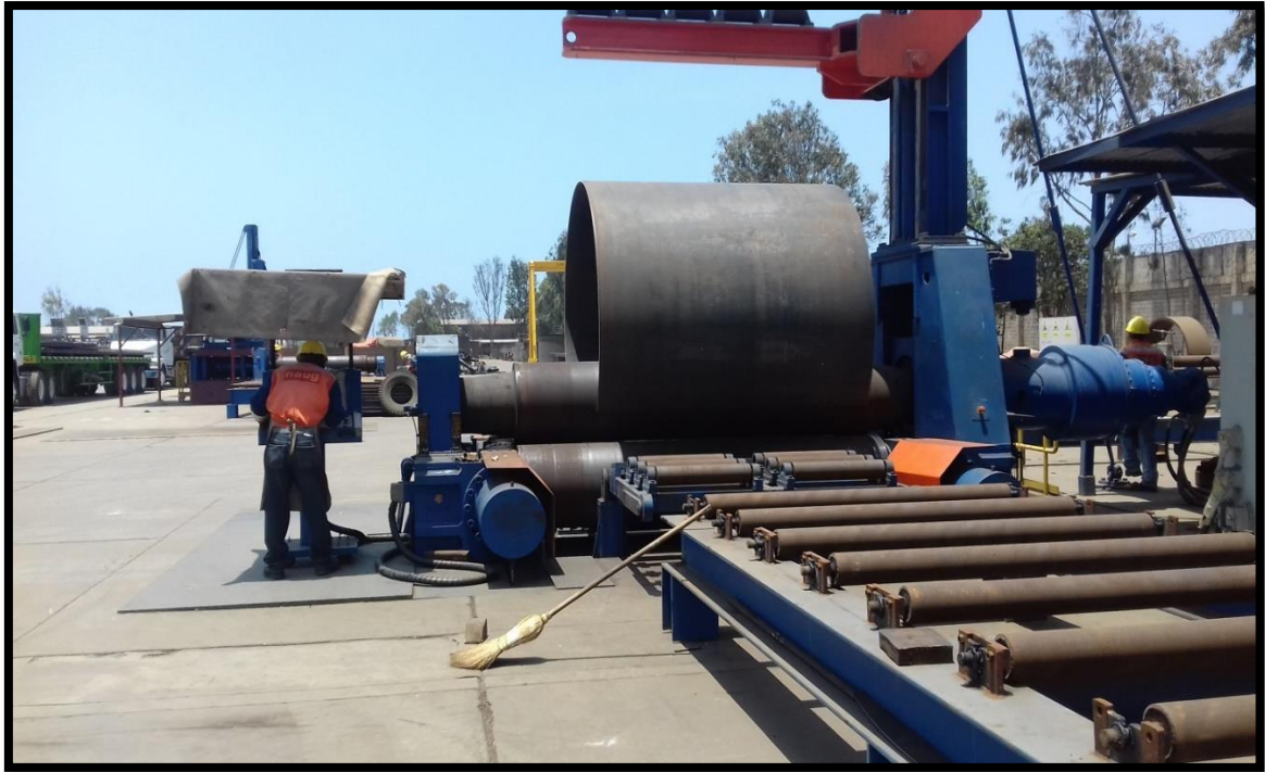
Imagen A.7.3. Proceso de rolado de planchas para cascos del tanque.
