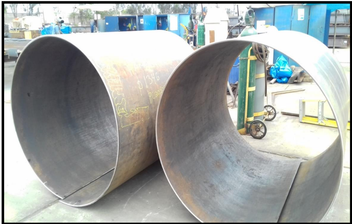
Imagen A.7.4. Cascos Rolados del tanque.
