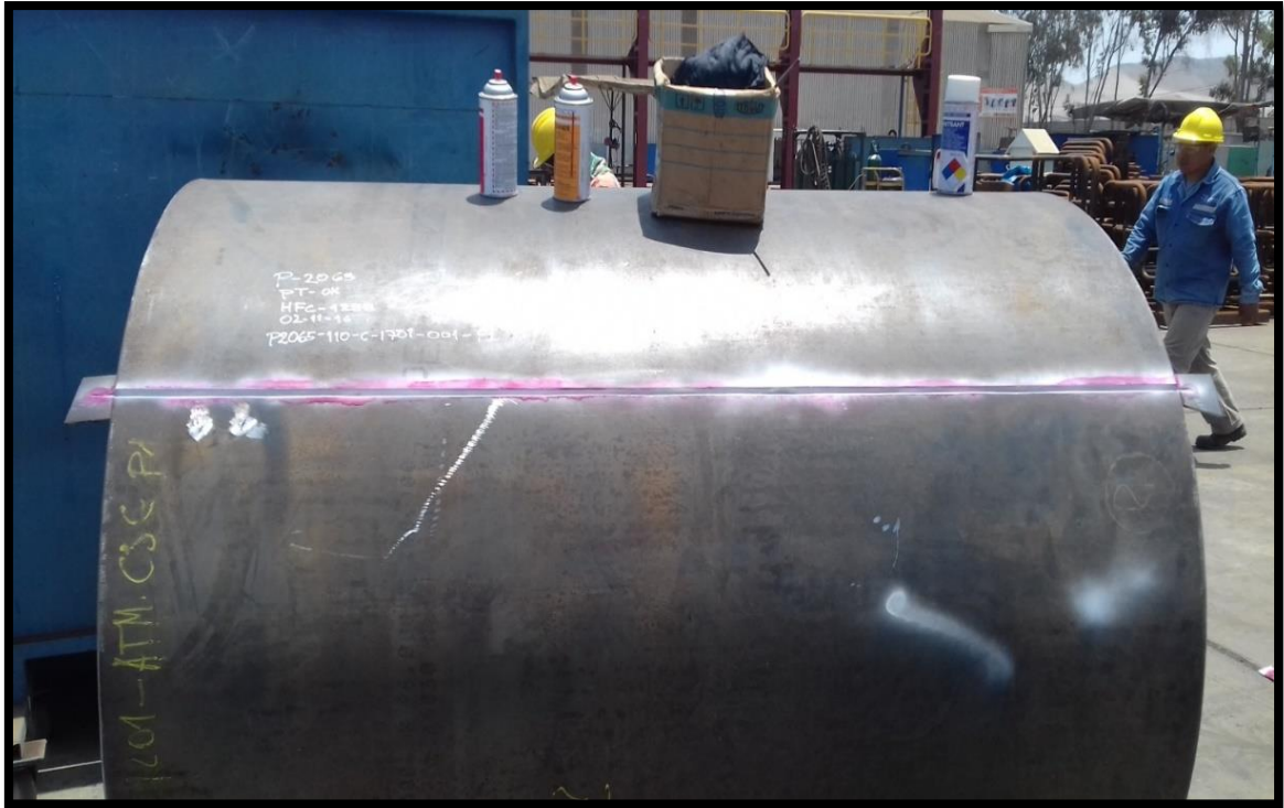
Imagen A.7.7. Aplicación de Tintes Penetrantes a la junta de raíz del casco.
