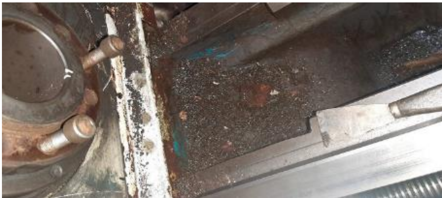
Figura 15. Viruta y humedad debajo de la bancada
