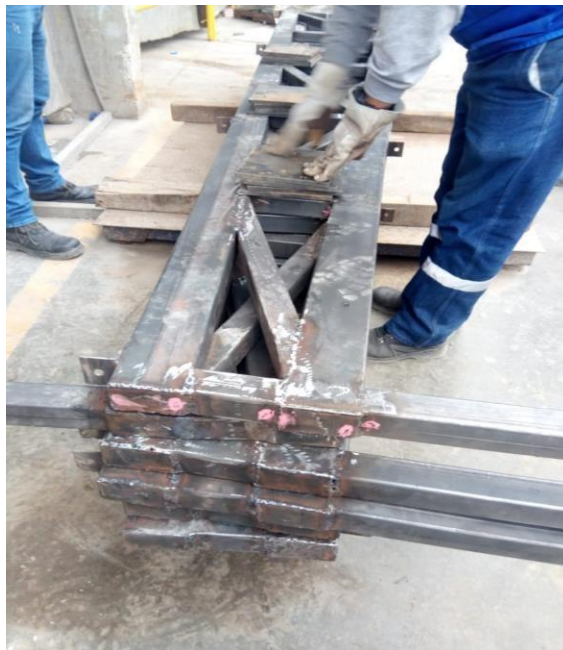
Figura 14. Material sin agujeros de entrada de zinc.
