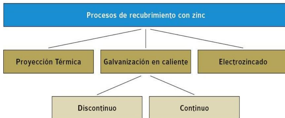
Figura 6. Procesos de recubrimiento de zinc
