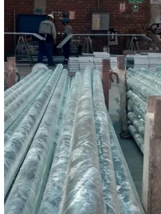
Figura 20. Rugosidad excesiva en el material.
