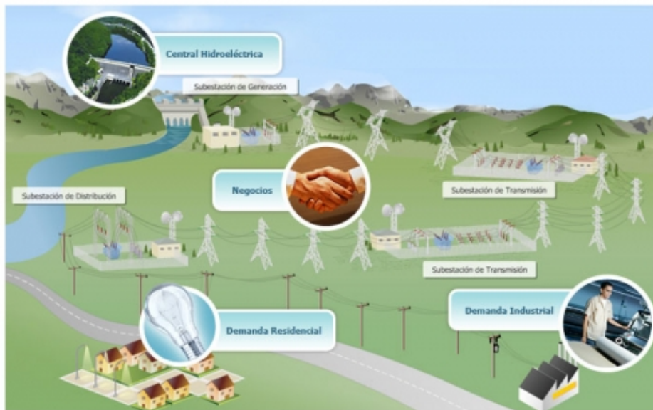
Figura 3: Sistema Eléctrico de Potencia
