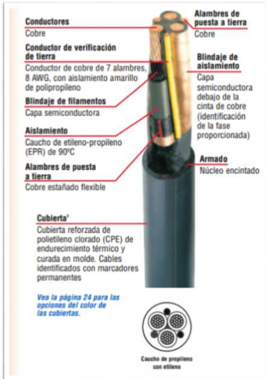
Figura N°1: Construcción estándar (cable de mina).
