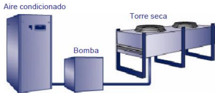
Figuras 22.Sistema de Refrigeración por Glicol.
