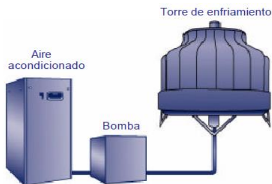
Figura 21. Sistema de Refrigeración por Agua.
