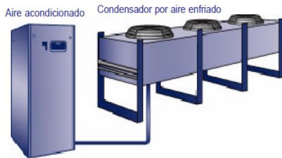
Figura 20. Sistema de Refrigeración por Aire.
