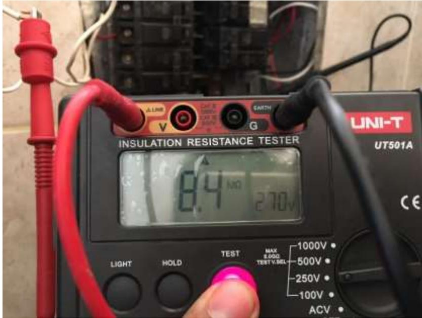
*Ilustración 15. Bajo nivel de aislamiento*
