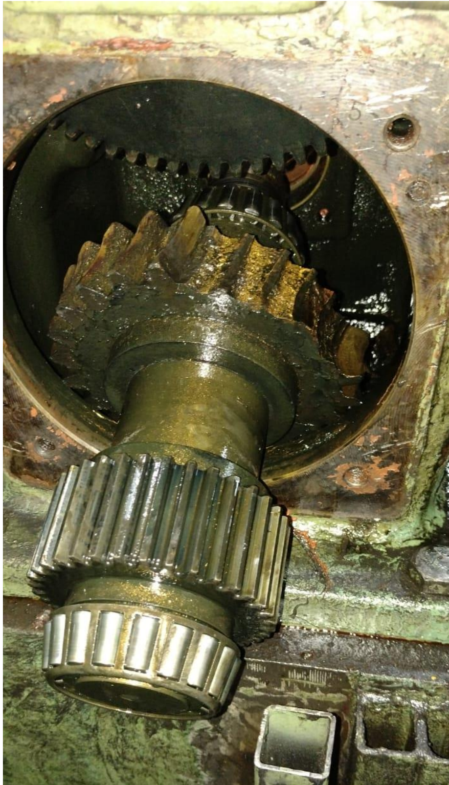
Figura 3.11 Estado en el que se encontró corona barrida
