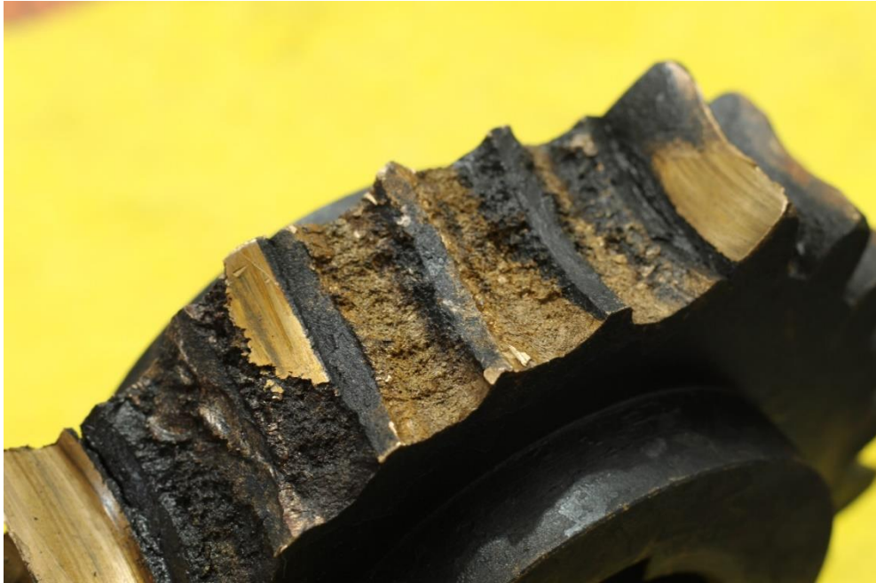
Figura 3.13. Fotografía de piñón con dientes barridos.
