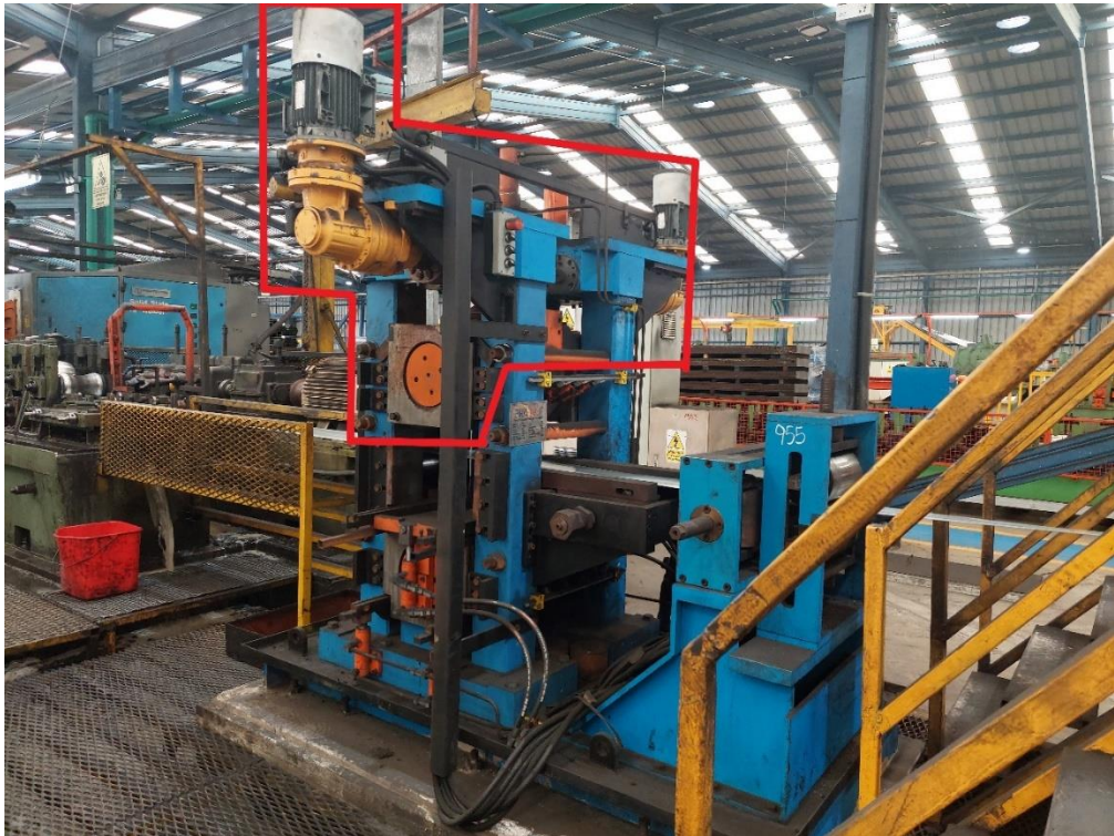
Figura 3.23 Sistema de fuerza de laminador señalado
