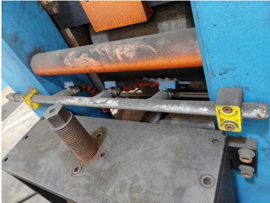
Figura 3.24 Sistema de lubricación, rótulas articuladas
