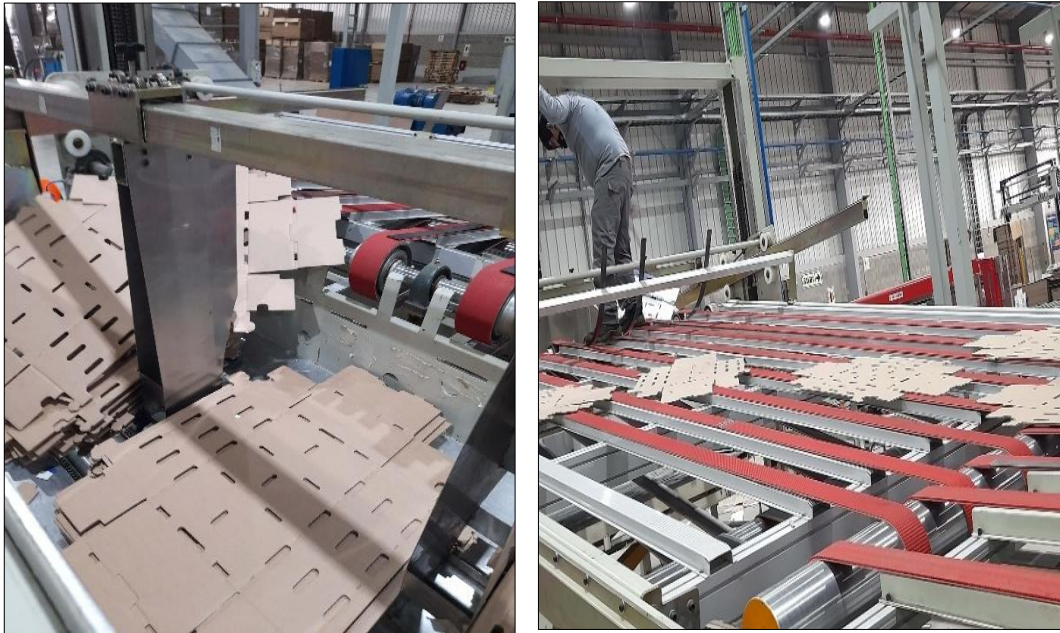
Figura 9: Atascamiento de cajas por fallas mecánicas
