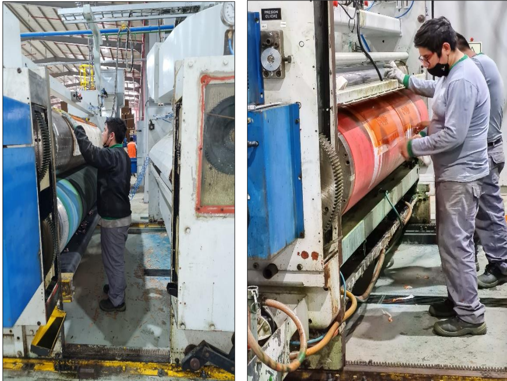
Figura 6: Cambio de producto para puesta en marcha
