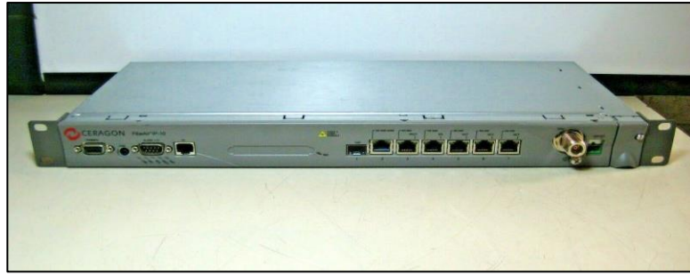
Figura 29. IDU Ceragon IP-10 FibeAir Fuente: ebay.com
