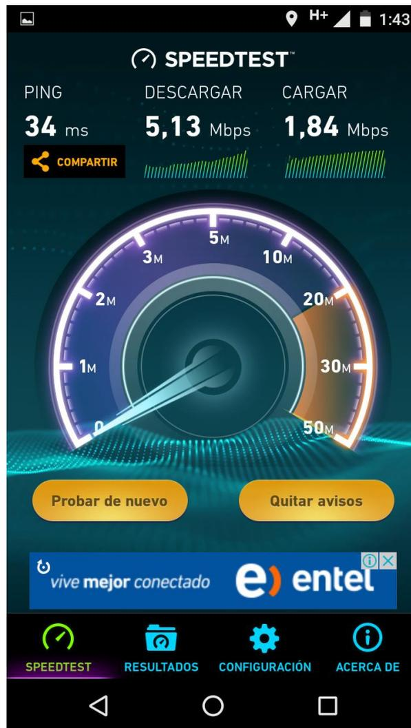
*Figura 33.* Detalles de la pruebas Downlink y Uplink con la aplicación del Speed Test
