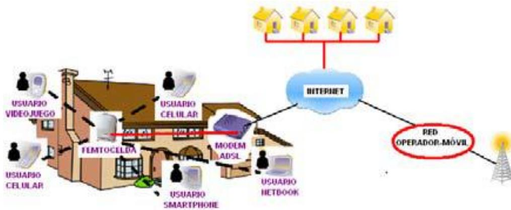
*Figura 6.* Perspectiva general de una red móvil con femtoceldas
