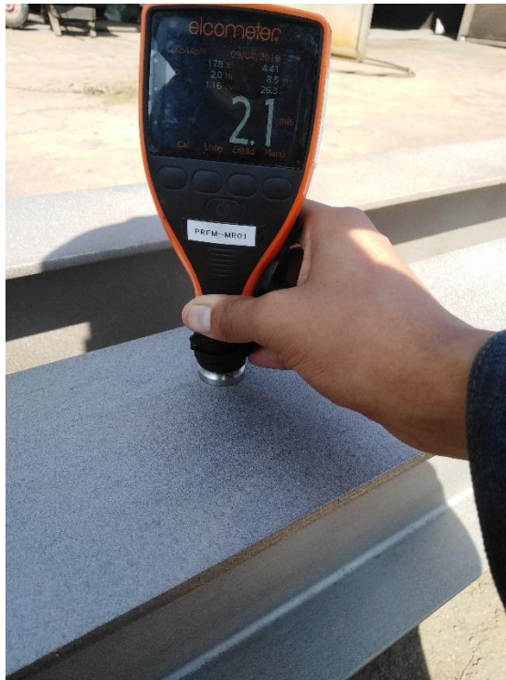
Figura 16. Medición de perfil de anclaje en vigas H
