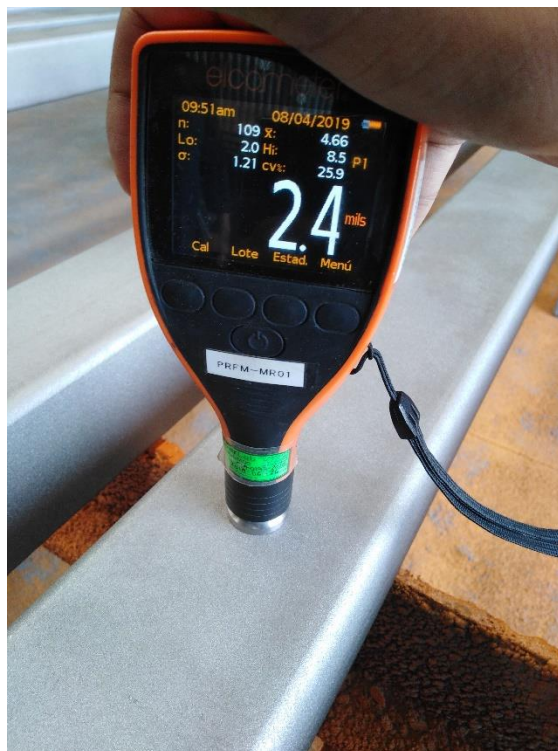
Figura 15. Medición de perfil de anclaje en tubos
