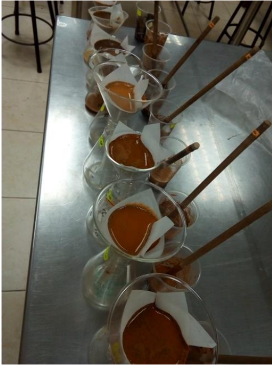
Figura 35. Medición de Conductividad Eléctrica del suelo (28/09/2019). (Derecha).
