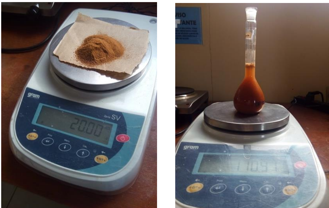
Figura 33. Determinación de densidad real de suelo, Laboratorio Edafología UNTELS (04/09/2019).
