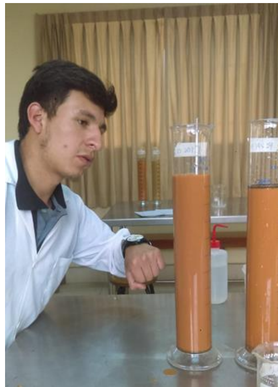
Figura 31. Toma de lectura con el hidrómetro para determinar textura. (derecha).
