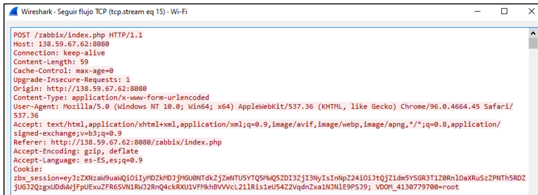
Figura 30. Resultados del análisis wireshark sin VPN
