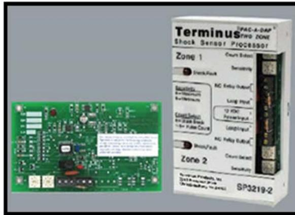
Figura N° 16: tarjeta procesadora de señales de vibración UL
