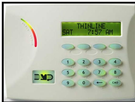
Figura N° 06: keypad teclado de alarma DMP
