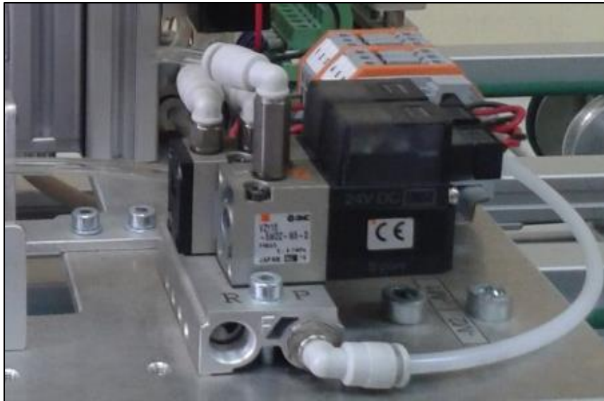
Figura 29. Válvulas 3/2 instaladas en cada estación
