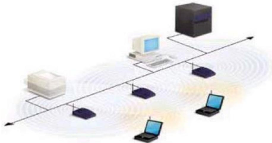
*Figura 2. Utilización de varios Puntos de acceso.*
