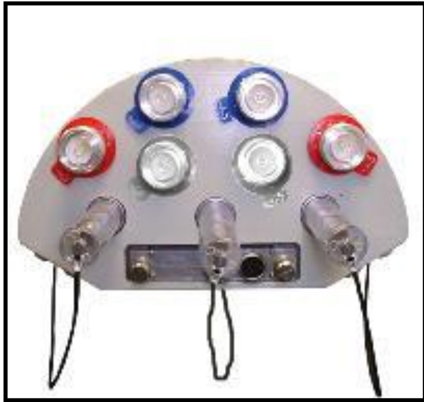
FIGURA N° 3.13: ANTENA TRIBANDA USADA PARA COBERTURA LTE.
