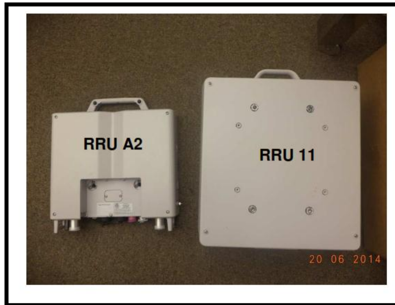
FIGURA N° 3.16: RRU'S PARA 4G DE ERICSSON.
