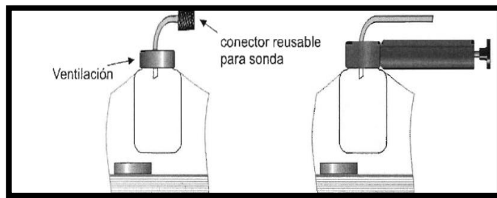
Figura N° 30 bombas de vacío
