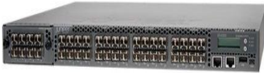
Figura N° 16: Vista frontal del equipo EX4500
