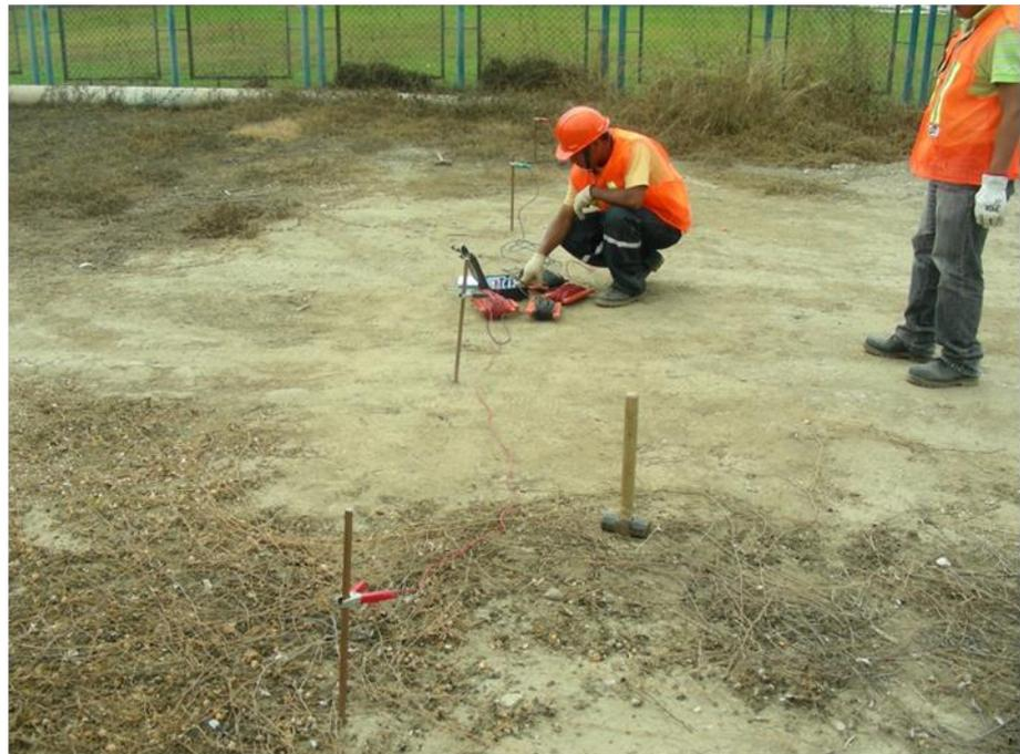
Figura 3.3. Medición de Resistividad - S.E. Trujillo Sur.
