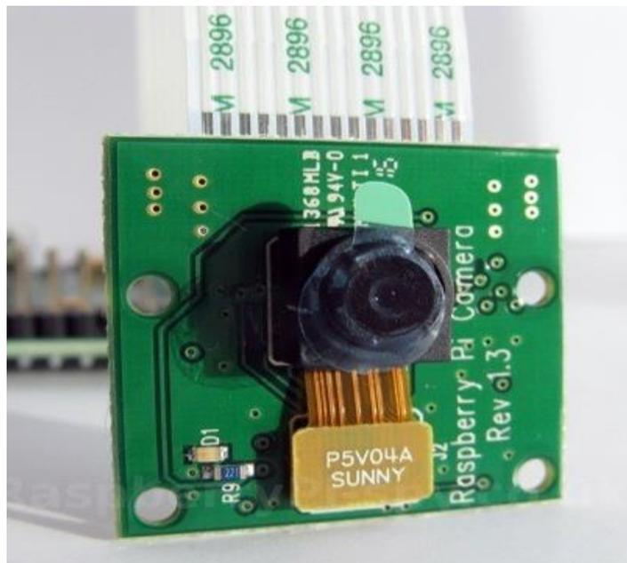
Figura 4. Cámara del Raspberry Pi 3
