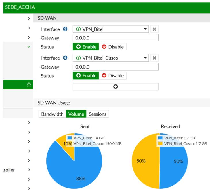
**Nota:** El porcentaje de tráfico de salida tiene un porcentaje del 12% por el enlace VPN\_Bitel\_Cusco y un porcentaje de uso de 88% por el enlace VPN\_Bitel; en el caso de tráfico entrante, se tiene una proporción de 50% tanto por VPN\_Bitel y VPN\_Bitel\_Cusco.
