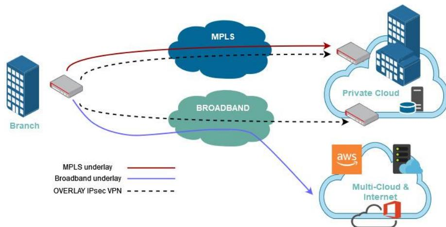
**Nota:** Existen dos interfaces físicas WAN1 y WAN2, sobre diferentes tecnologías, las cuales pueden ser miembros del SD-WAN al igual que las interfaces virtuales de los túneles IPsec. Adaptado de Fortinet Secure SD-WAN Reference Architecture (p.9) de, Fortinet, 2019.
