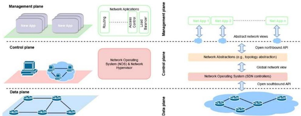
**Nota:** El gráfico muestra que los planos separados se interconectan mediante la utilización de API del tipo Southbound y Northbound. Adaptado de <sup>18</sup> *Software-Defined Networking: A Comprehensive Survey* (p.24), de Kreutz, et al, 2015, IEEE, 103.
