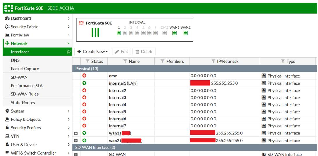
**Nota:** Se visualiza que los puertos en que están activos tanto lógicamente como físicamente, son los Internal1, el cual está conectado directamente al Switch de acceso de Agencia, wan1 que es conectado al router del ISP-1 y wan2 que va conectado al router del ISP-2.
