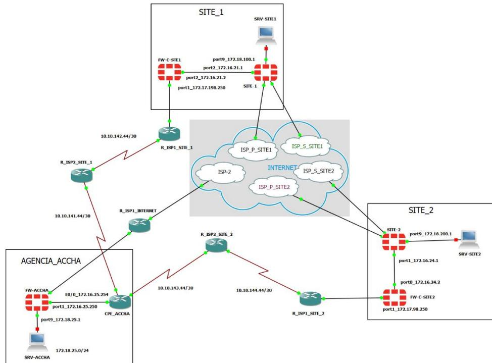
**Nota:** Se simuló la infraestructura de conectividad de la Agencia Accha, hacia el Site 1 y Site 2. Se visualiza que la agencia Accha tiene servicio de MPLS por el proveedor ISP-2 y salida a internet directa mediante el proveedor ISP-1.
