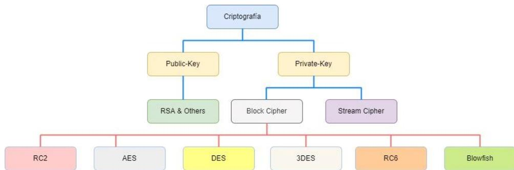
**Nota:** Como se muestra en el gráfico, los mecanismos de cifrado AES, 3DES y DES se clasifican como simétricos, debido a que solo emplean la llave privada tanto para cifrar como descifrar la información. Adaptado de *Performance Evaluation of Cryptographic Algorithms: DES and AES* (p.1), port Mandal, et al, 2012, IEEE.
