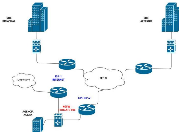
**Nota:** Fortigate 60E conectado directamente con el router CPE del ISP-1 de salida a internet directa y el CPE del ISP-2 que brinda el servicio de RPV para la interconexión entre sedes.
