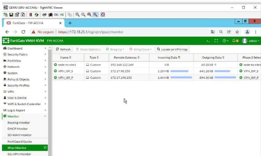
**Nota:** El tráfico hacia los recursos de lima se realizan mediante el túnel VPN\_ISP\_P principalmente, siendo el túnel sede-to-site1 el enlace de contingencia, por ello solo se muestra tráfico bidireccional en VPN\_ISP\_P.
