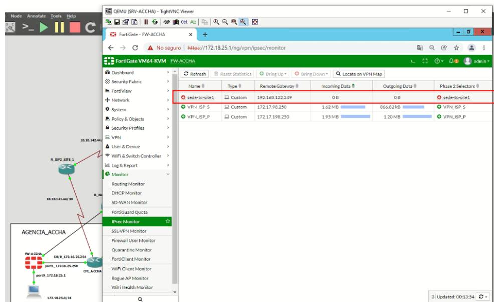
**Nota:** Los túneles que siguen activos luego de la caída a internet del Site principal, son el VPN\_ISP\_S y el VPN\_ISP\_P, debido a que ambos Remote Gateway se encuentran dentro de la red MPLS del proveedor ISP-2 de cara al FW-ACCHA.
