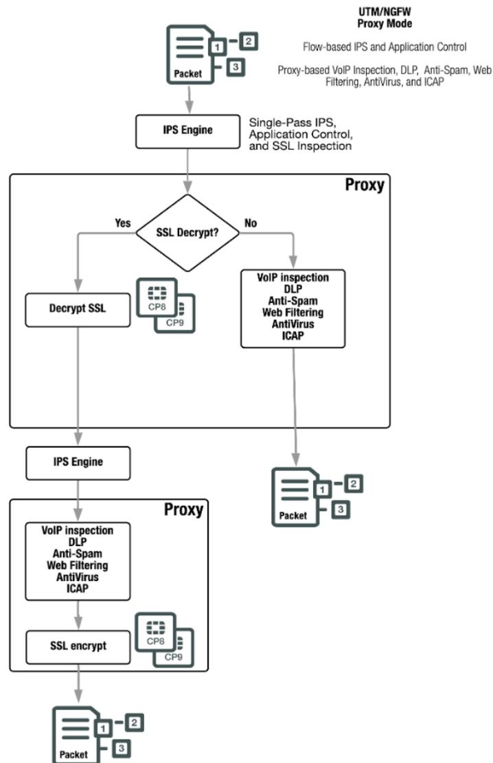
**Nota:** La desencriptación y encriptación de los paquetes, al realizar el análisis de inspección profunda, está condicionado según las categorías configuradas en el SSL/Inspection a ser baipaseadas. Adaptado de FortiOS- ParallelPath Processing (p.22) de, Fortinet, 2019.
