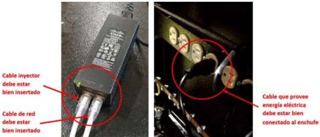
Figura 3.38. Equipo POE - Power Over Ethernet.
