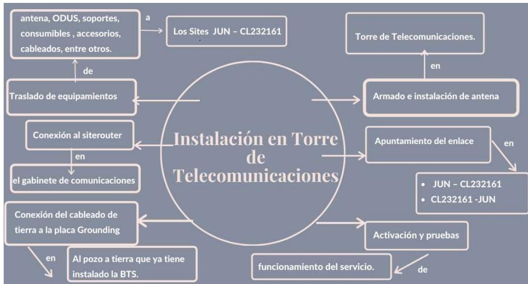
*Figura 3.18.* Diagrama de Bloques de Instalación en torre de Telecomunicaciones.
