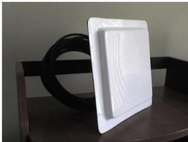
Figura.05. Antena Panel
