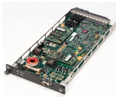
Fotografía 5. Tarjeta de Protección de Nodos
