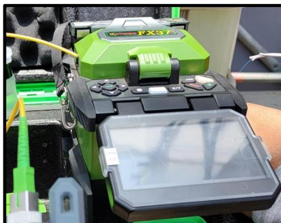
Figura 30: Máquina empalmadora FX-37
