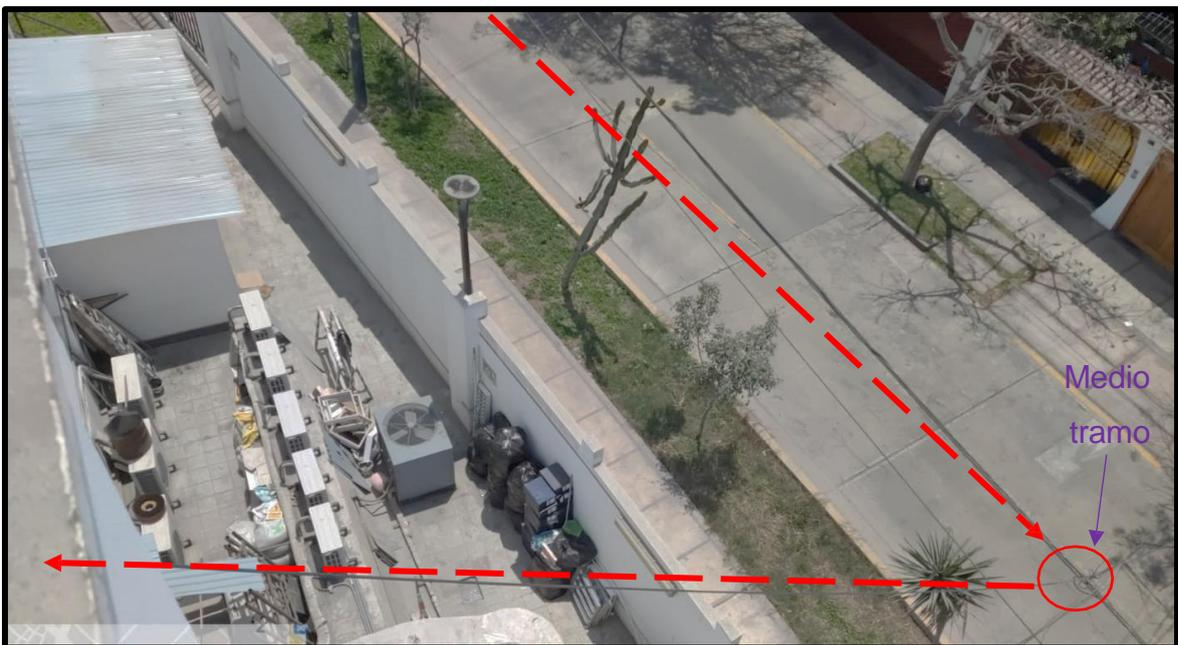
Figura 51: Fibra óptica ingresa por medio aéreo al predio del abonado
