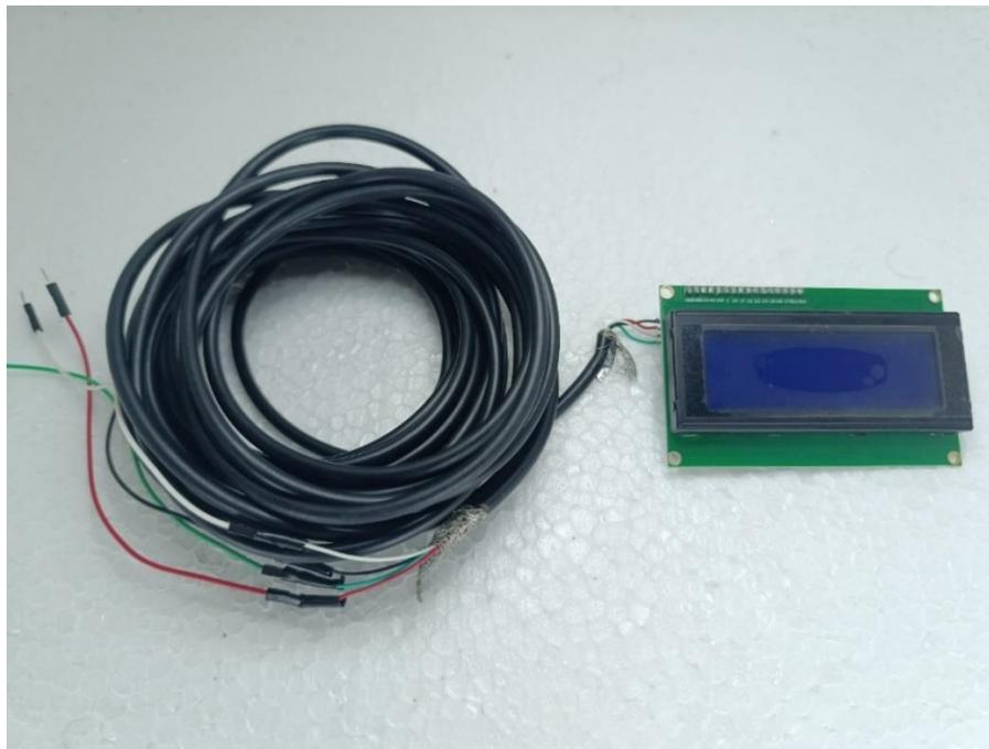
*Nota.* La pantalla LCD 4x20 tiene que soldarse un puerto I2C para su posterior uso. Elaboración propia.
