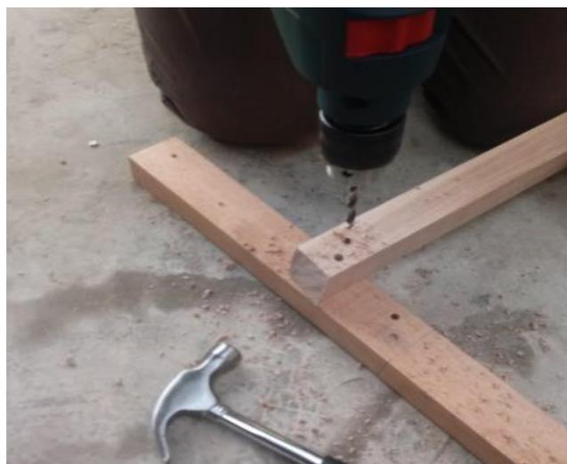
**Figura 30.** Perforado de madera para unión de partes.
