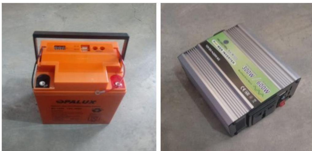
**Figura 27.** Batería y convertor de energía.
