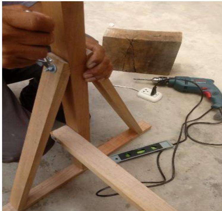
**Figura 31.** Incorporación de la base al soporte del sistema.
