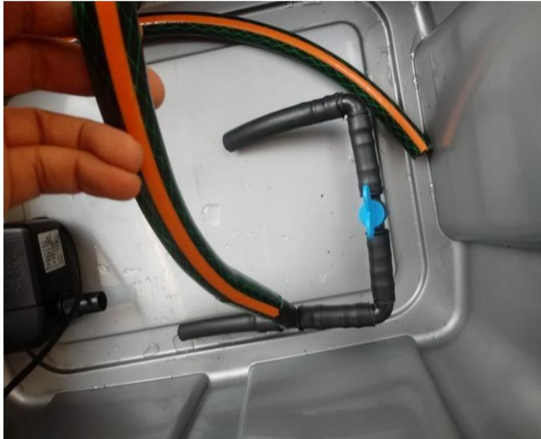
**Figura 35.** Conexión interna del contenedor para el ingreso de solución.
