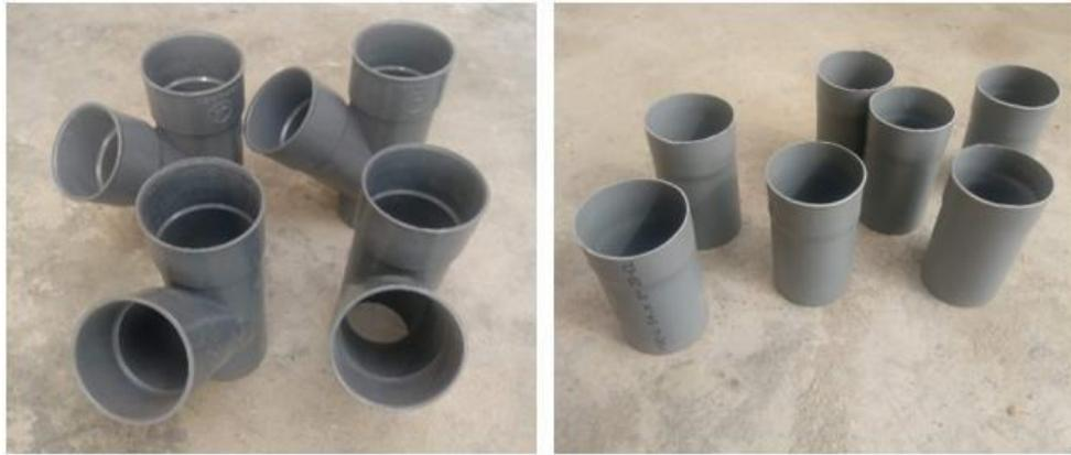
**Figura 19.** Tubos "Y" y piezas cilíndricas de PVC.
